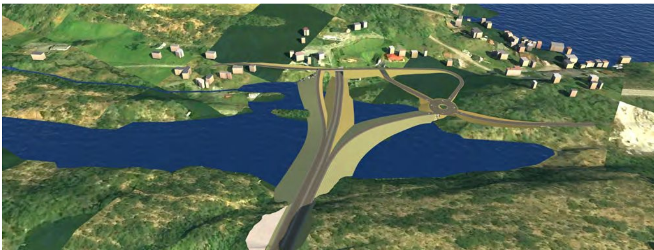
Figur 6-31 Ny E39 kryssar Hjelmåsvatnet på fylling, og det vert kryss med eksisterande E39 på staden. Dette er eit halvt kryss med sørvendte rampar. Ny E39 kryssar landskapsrommet på tvers av landskapsformene. Illustrasjon: InfraWorksmodell.
