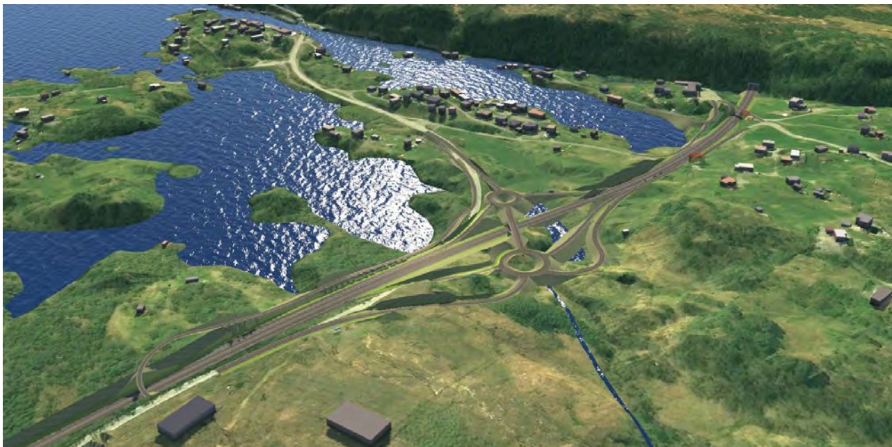
Figur 6-34 Ny E39 kryssar Eikangerbygda i daglinje, tett ned mot vågane. Det vert nærføring mot skulen, rett vest for denne. Det vert og eit fullt toplanskryss rett vest for eksisterande E39. Illustrasjon: InfraWorksmodell.
