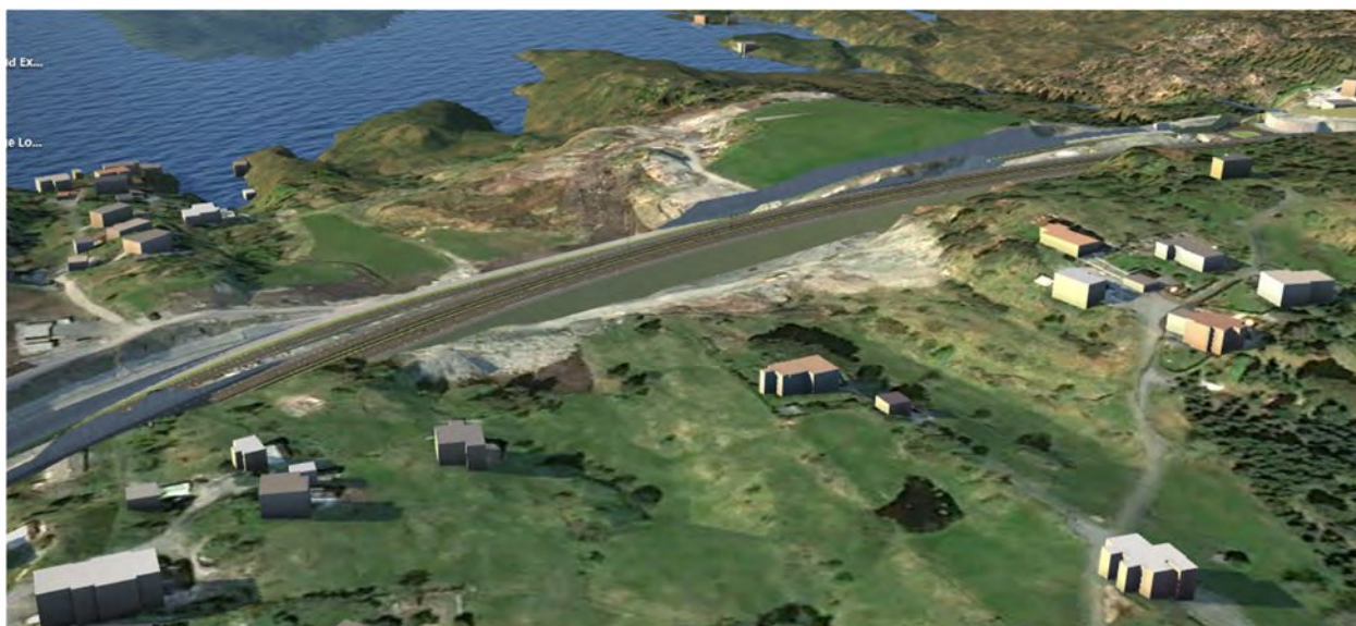
Figur 6-4 Nytt lokalvegssystem vert lagt parallelt med ny E39, på vestsida av vegen. Det vert skjeringar på austsida og vestsida av ny E39. Illustrasjon: InfraWorksmodell.
