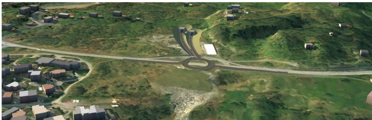
Figur 6-13 Rundkøyring for kopling til ny E39 vert plassert nord for Oteråsen. Det vert nordvendte rampar av og på ny E39. Illustrasjon: InfraWorksmodell.
