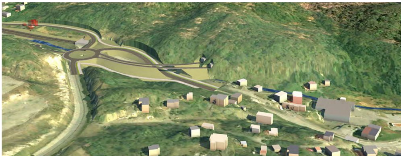
Figur 6-20 Nytt lokalvegssystem vert lagt under tunnelrampene som koplar seg på inne i tunnel for ny E39. Lokalvegen vert lagt over tunnelportal for ny E39. Kryss og tunnelportalar fører til eit stort og skjemma landskapsinngrep i dalrommet. Illustrasjon: InfraWorksmmodell.
