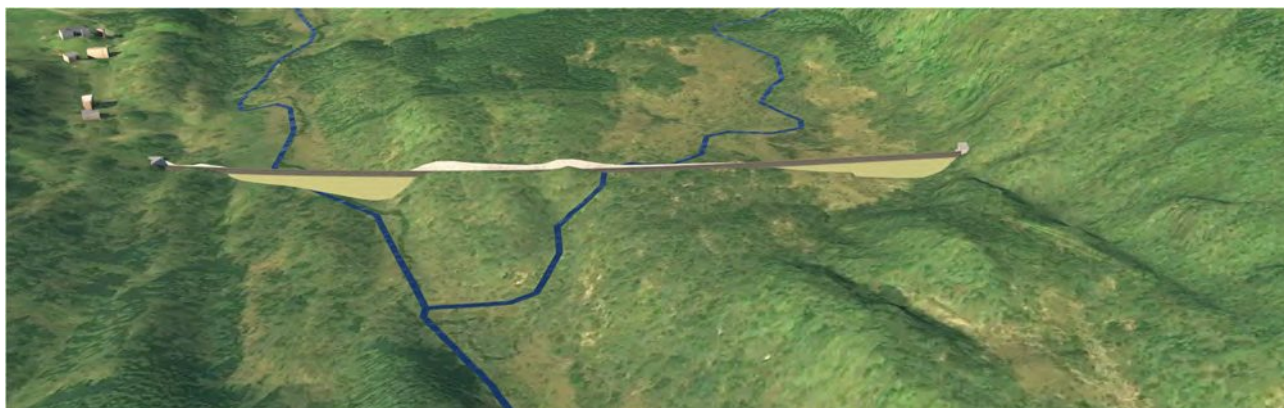
Figur 6-18 Ny vegarm frå Øvre Isdal til Alversund skjer seg gjennom landskapet på Tveiten. Illustrasjon: InfraWorksmodell.
