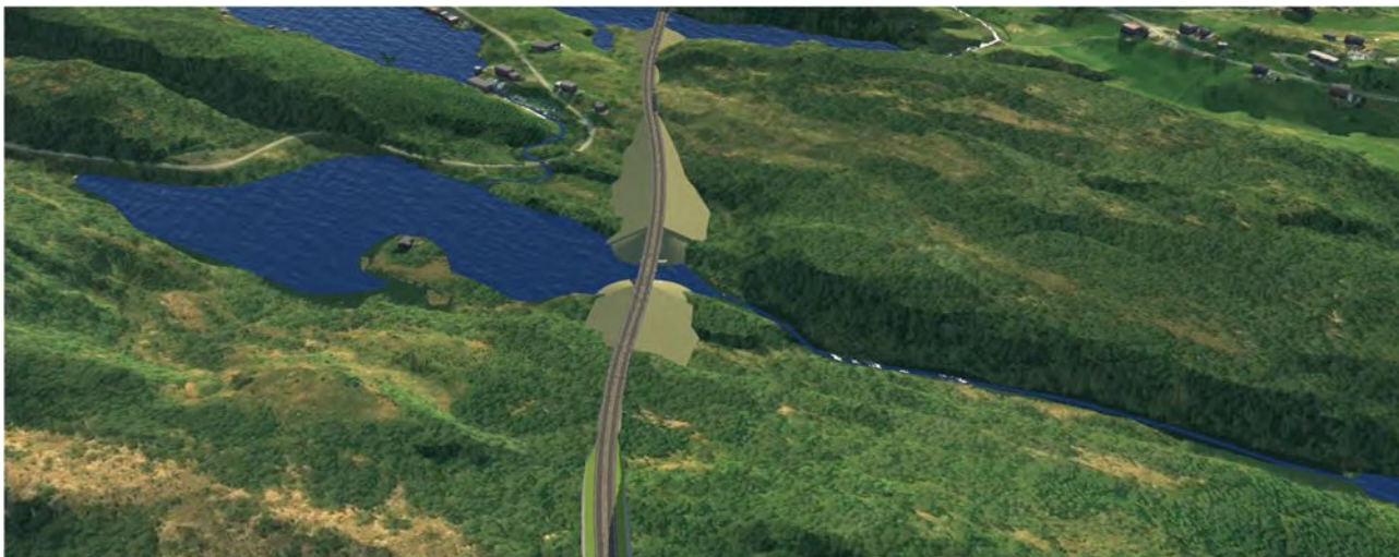
Figur 6-42 Illustrasjonen syner kryssing av nordenden av Sauavatnet på bru, med høge fyllingar på kvar side av brua. Vegen er ført på tvers av landskapet sine hovudformer. Illustrasjon: InfraWorksmodell.
