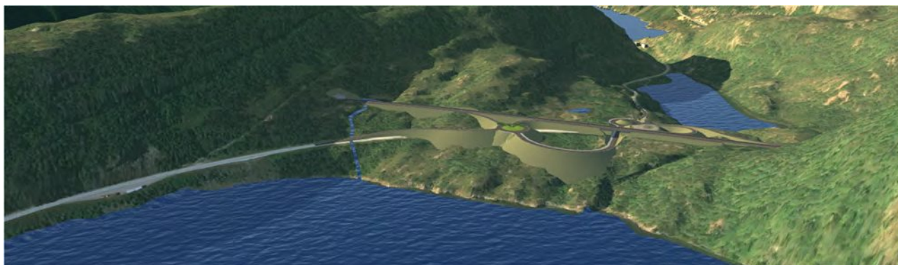
Figur 6-48 Ny E39 ligg godt i landskapsrommet, men for å få rett stigning på tilkopling mellom ny E39 og Austfjordvegen vert det ei lang sløyfe som råkar naturområdet mellom eksisterande E39 og Husdalsvatnet. Det vert laga ei løysing med fullt kryss, eit toplanskryss med på- og avkøyring både mot nord og sør. Illustrasjon: InfraWorksmodell.
