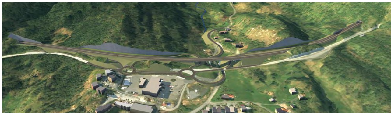
Figur 6-47 Ny E39 vert lagt på vestsida av eksisterande veg, og det vert laga ei løysing med fullt kryss med på- og avkøyringsrampar både mot nord og sør. Det vert store terrenginngrep i samband med bygging av ny veg og kryss, mykje av arealet mellom ny og gamal E39 må planerast ut og det vert høge skjeringar vest for ny E39. Illustrasjon: InfraWorksmodell.
