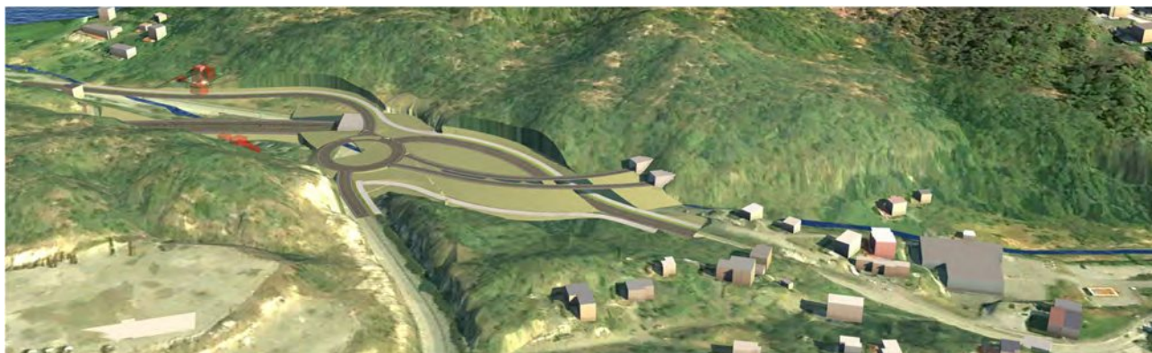
Figur 6-26 Nytt lokalvegssystem vert lagt under tunnelrampene som koplarseg på inne i tunnel for ny E39. Lokalvegen vert lagt over tunnelportal for ny E39. Kryss og tunnelportalar fører til eit stort og skjemmande landskapsinngrep i dalrommet. Illustrasjon: InfraWorksmmodell.
