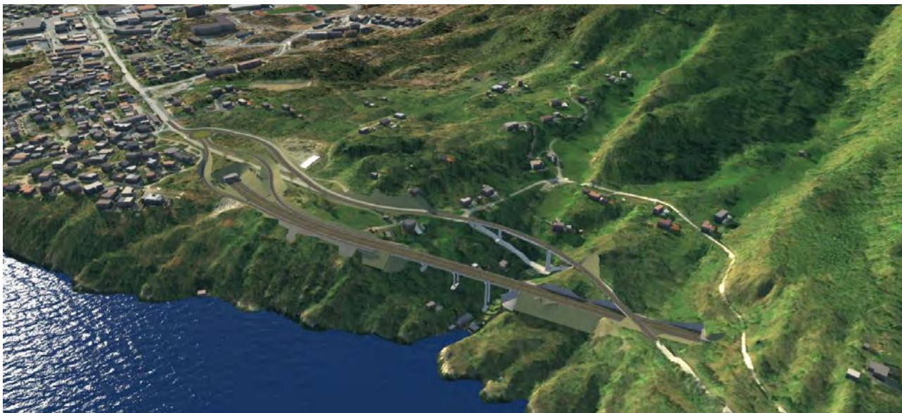
Figur 6-11 Tunnelinnslag for ny E39 ligg rett nord for Oteråsen, med nordvendte rampar for av- og påkøyring til ny E39. Illustrasjon: InfraWorksmoell.
