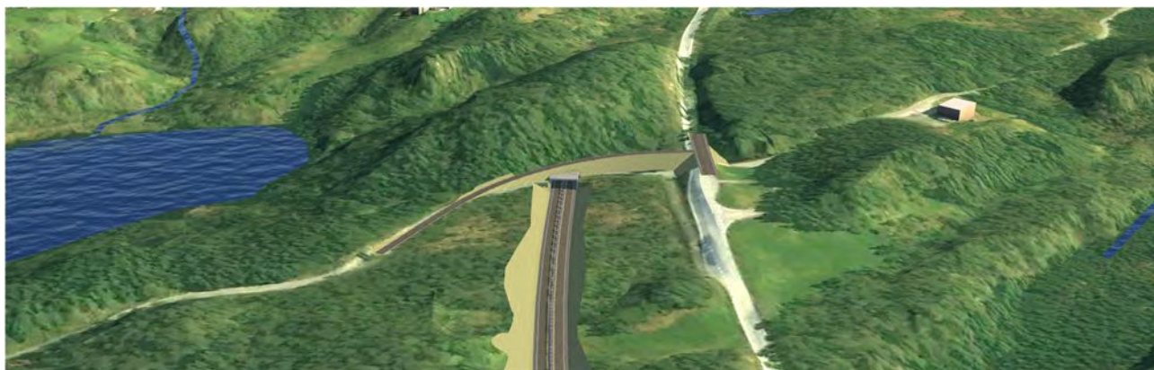
Figur 6-46 Illustrasjonen syner Bjørndalsvatnet til venstre, og korleis ny E39 vert lagt inn i tunnel under Hindenesvegen. Illustrasjon: InfraWorksmmodell.
